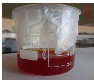
Figura 2: Solução de ácido polivanádico ( HVO_3 ) já transformada em pentóxido de vanádio ( V_2O_5 ).
